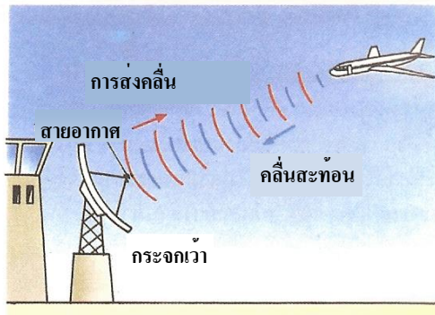
ภาพที่ 7.14 คลื่นไมโครเวฟ หาตำแหน่งวัตถุด้วยหลักการสะท้อนของคลื่น ที่มา (ประมวล คิริพันธ์แก้ว และวิสูตรพึ้งเย็น, 2547, หน้า 447)
