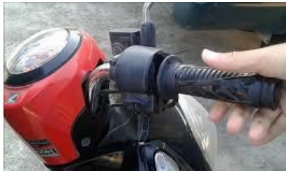
แฮนด์เร่งเครื่องยนต์ใช้ผิวสัมผัสช่วยยึดเกาะ รอยนิ้วมือเพิ่มแรงเสียดทานในการยึดจับ
